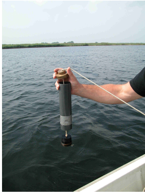
Met een speciale waterhapper wordt een monster water uit de diepte gehaald. De waterhapper bestaat uit drie delen en een lang touw.
